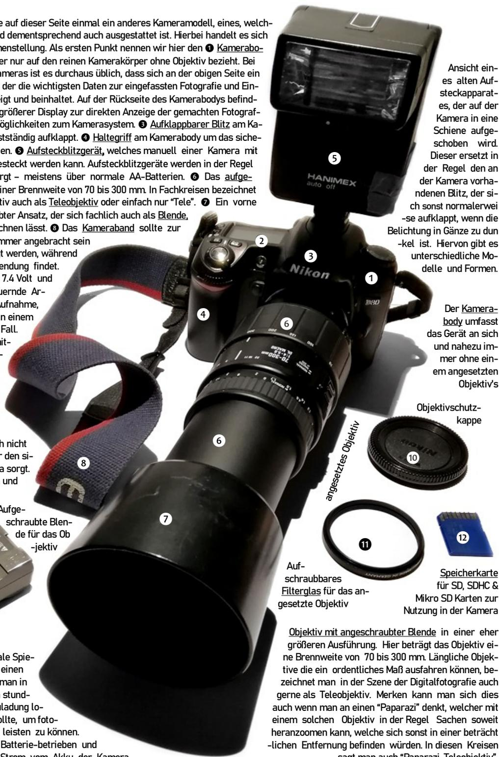
Ansicht eines alten Aufsteckapparates, der auf der Kamera in eine Schiene aufgeschoben wird. Dieser ersetzt in der Regel den an der Kamera vorhandenen Blitz, der sich sonst normalerweise aufklappt, wenn die Belichtung in Gänze zu dunkel ist. Hiervon gibt es unterschiedliche Modelle und Formen.
